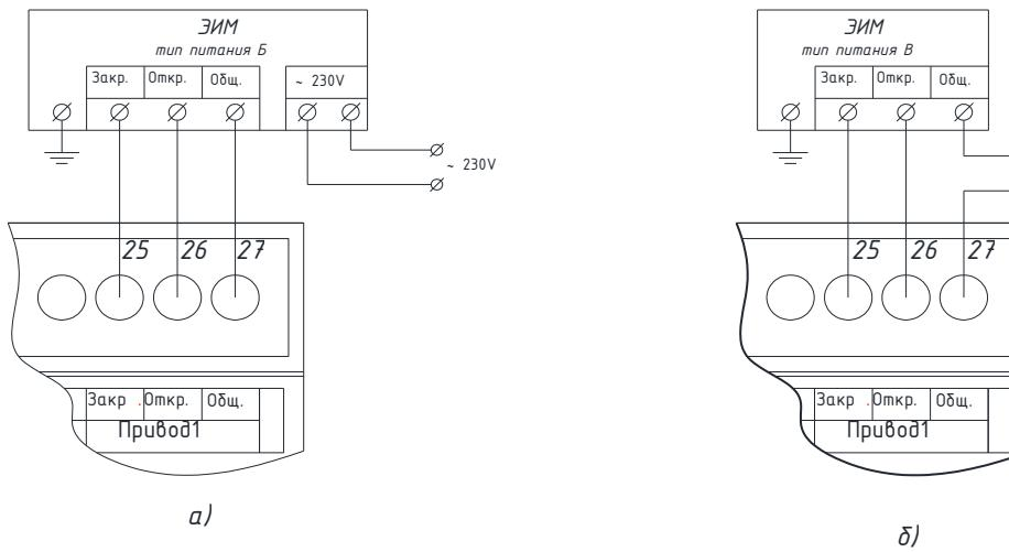
Рисунок 3 - Пример подключения исполнительных звеньев с типами питания Б и В электроприводов: а – тип питания Б; б – тип питания В
