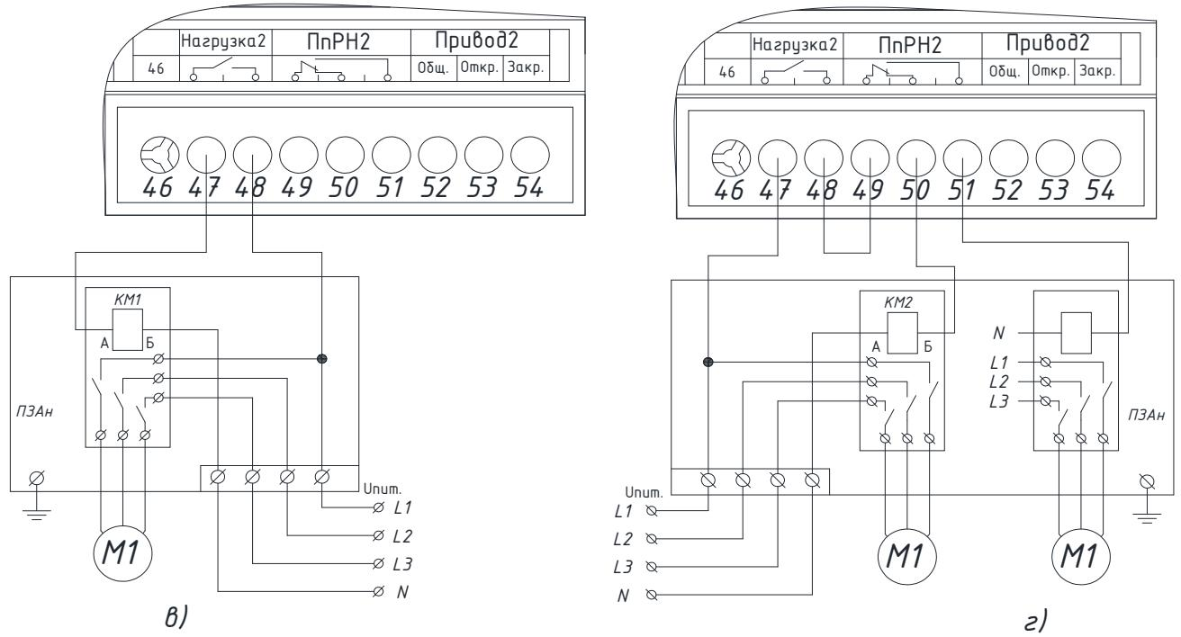
Рисунок 4 - Пример подключения циркуляционных насосов в системах отопления и ГВС: а – одинарных однофазных; б – сдвоенных однофазных; в – одинарных трехфазных; г – сдвоенных трехфазных
