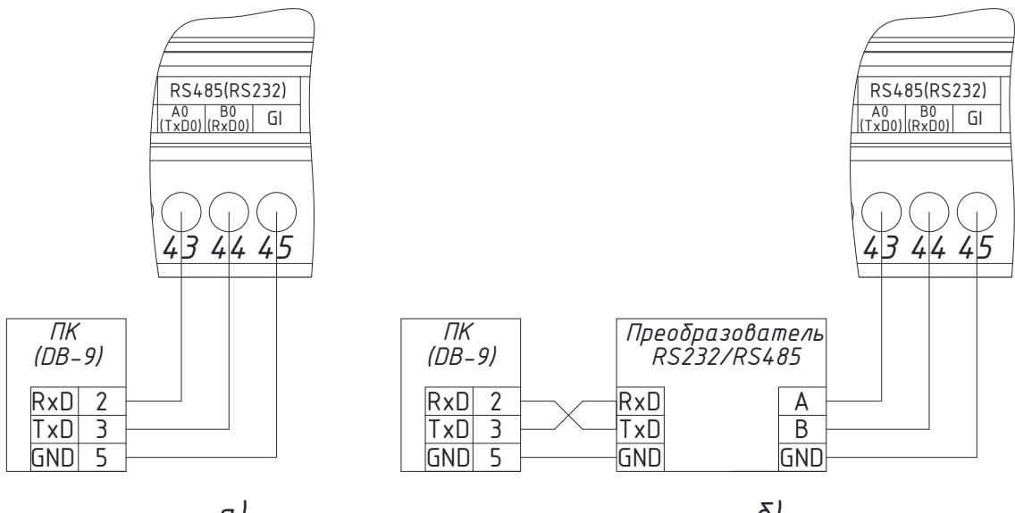
Рисунок 6 – Пример подключения контроллера через интерфейсы: а – RS232, б – RS485
