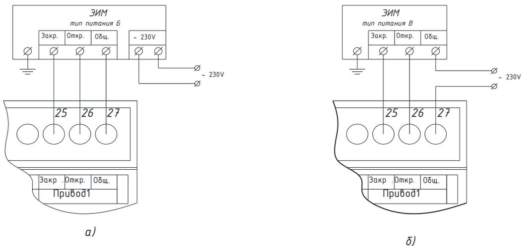
Рисунок 3 - Пример подключения исполнительных звеньев с типами питания Б и В электроприводов: а – тип питания Б; б – тип питания В
