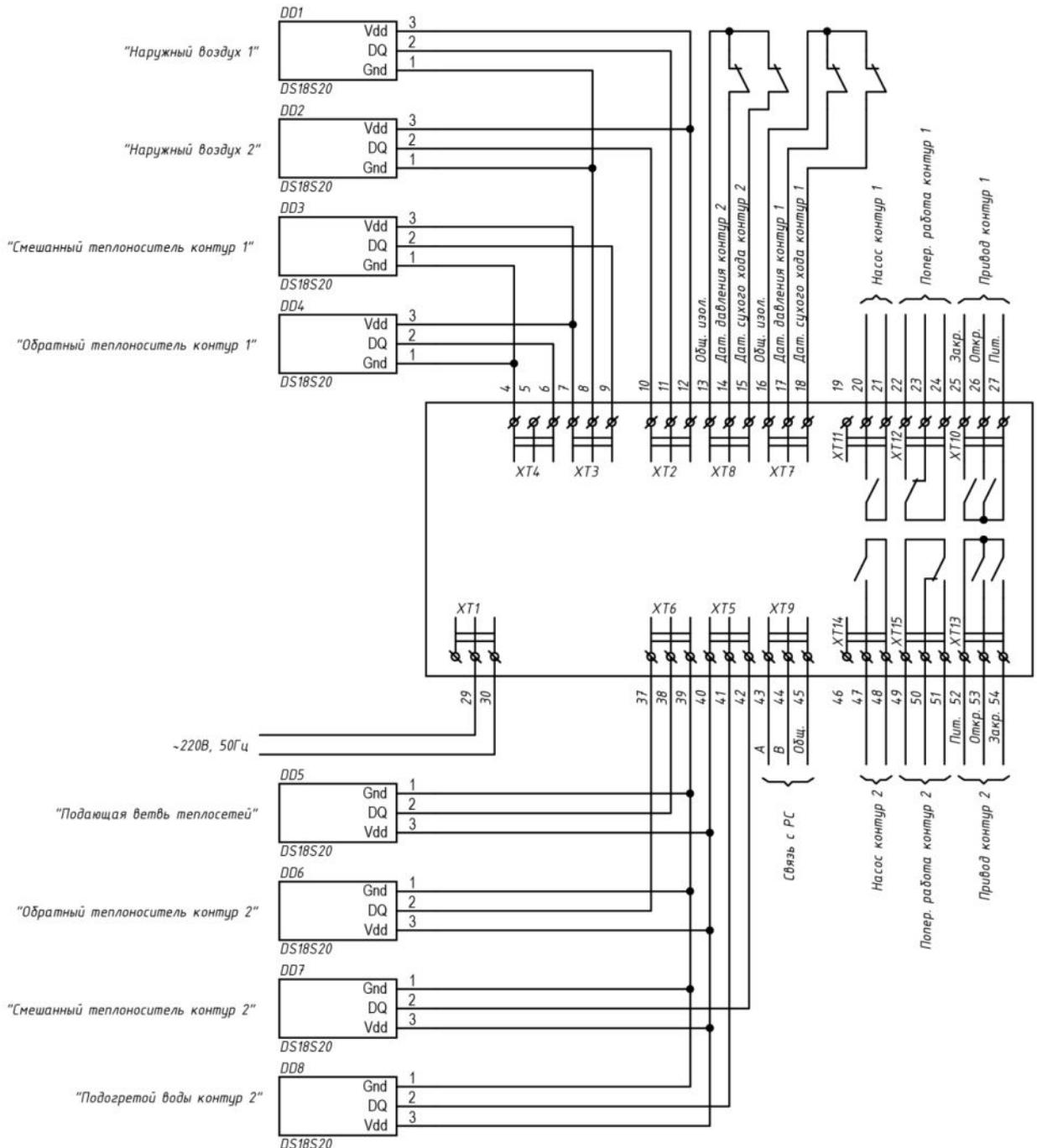
Рисунок 2 - Функциональная схема и подключение внешних соединений.
